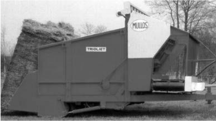
Figuur 8.10 Kuilblokkendoseerwagen in werking
